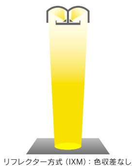
リフレクター方式（IXM）：色収差なし
